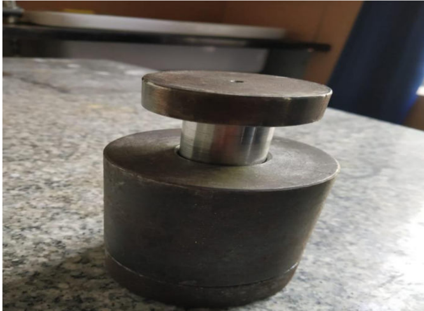
Figure: 4.4 Die and plunger (EN32 steel die)
